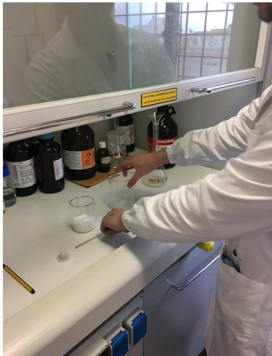
Preparazione della soluzione di NaOH 6M
